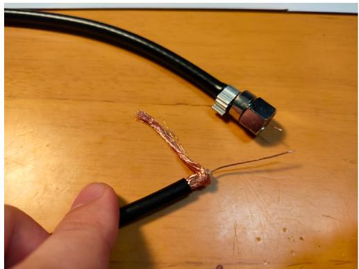
▲同軸ケーブルの加工が完了した所。一方にはコネクタをつけ、もう一方は芯線と編組線をT字に分けておく。
