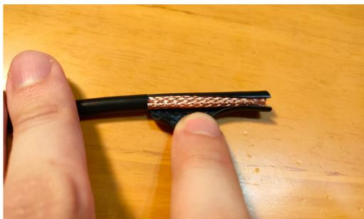
▲同軸ケーブルの外皮に入れた縦の裂け目は、横に入れた軽い切れ目で止まる。その後、横のカッター切れ目に沿って外皮を剥がすことができる。
